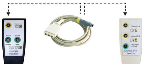
Abbildung 4: Anschluss des EMG-Kabels
