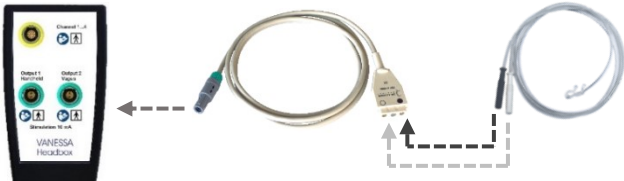
Şekil 1: Saksafon elektrodunu (Madde No. 42-0068) adaptör (Madde No. 41-0080) ve VANESSA headbox'a takma
