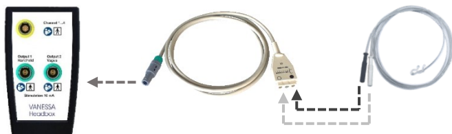
Εικόνα 1: Σύνδεση του ηλεκτροδίου τύπου σαξοφώνου (κωδ. προϊόντος 42-0068) με τον αντάπτορα (κωδ. προϊόντος 41-0080) και του VANESSA Headbox
