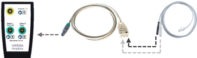
Figure 1 : Raccordement de l'électrode saxophone (réf. art. 42-0068) à l'adaptateur (réf. art. 41-0080) et au pré-ampli VANESSA
