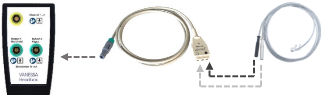
Figuur 1: Aansluiten van de saxofoonelektrode (artikelnummer 42-0068) op de adapter (artikelnummer 41-0080) en de VANESSA-headbox
