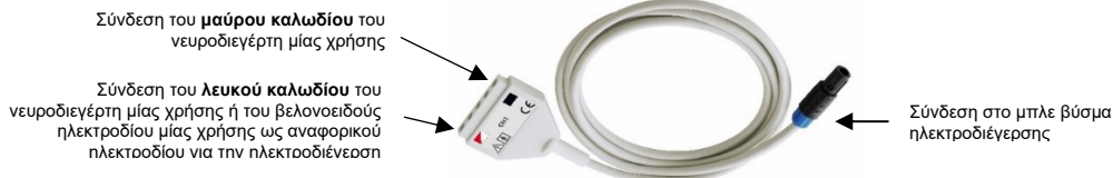
Εικόνα 2: Καλώδιο ηλεκτροδιέγερσης (αρ. καταλόγου: 41-0073) για τη σύνδεση των νευροδιεγερτών μίας χρήσης με συσκευές της Dr. Langer Medical GmbH
