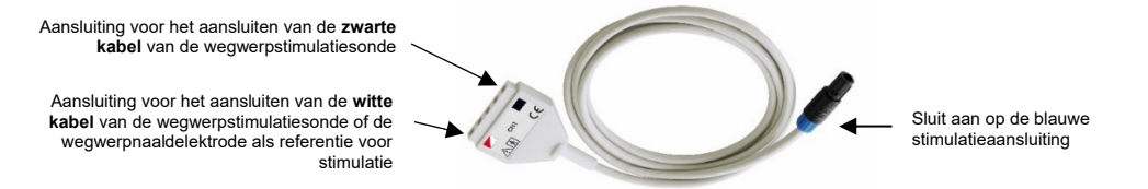
Figuur 2: Stimulatiekabel (artikelnummer 41-0073) voor aansluiting van de wegwerpstimulatiesondes aan apparatuur van Dr. Langer Medical GmbH
